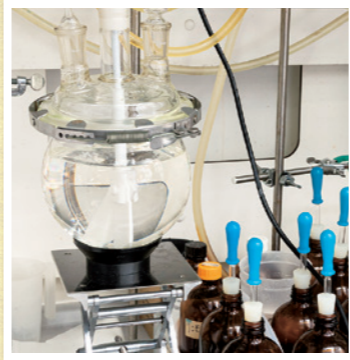
水に溶解するために2、3日攪拌を続ける。B-Lab独自のベタインは「バイオテックグランプリ2021」の最優秀賞を受賞。
