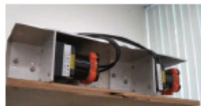
こんなセンサーです。見えないレーザーの壁を2枚作り、先に横切った方向から人が来たと判断します。
