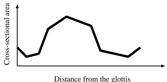
図1 円錐台の連続体で表した声道断面積関数
