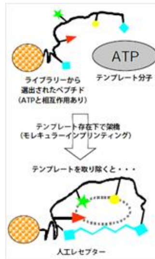
図1 モレキュラーインプリンティング ® の概念図。 テンプレートの存在下でペプチド（あるいは他の高分子）を架橋することにより、テンプレートに対して相補的な結合部位を持つ人工レプターが構築される
