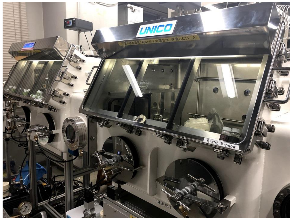
不活性気流下で試料を取り扱うためのグローブボックス
