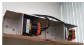
こんなセンサーです。見えないレーザーの壁を2枚作り、先に横切った方向から人が来たと判定します。
