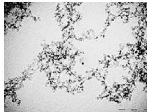
図2 ガス圧1100Paの凝集構造
