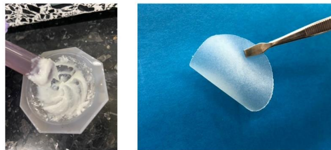
図2 モノマーを混合したポリ塩化ビニルスラリーと加熱圧縮成形により得られた可塑化膜
