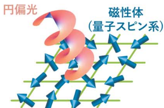
図3 磁性体に円偏光を当てることによる状態変化
