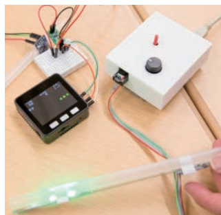
ストローに声を吹き込むと、赤や緑のライトが点灯したり、キャラクターを撃ち落としたりと、楽しみながらトレーニングできる器具。
