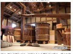
図 2. 撥ね木搾りでは、渋袋に入れた醪を右に置き、棒の左端 に吊した石の重さでテコの原理を応用して搾る。 薮田式では、 渋袋を板状のろ過膜に替え、空気の圧力で搾る。 精米機は、金剛ロールを回転させ、そこに米粒を押し付けることで米を磨 く。江戸時代には水車の動力を利用した。
