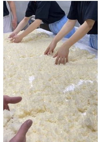
蒸米の上下を返す作業。両手で掬うように持ちひっくり返す。
