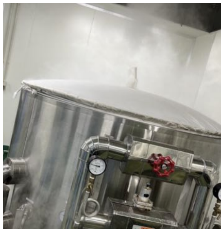
蒸米中の甑。煙突のような排気口をもつ木綿の分厚いフタを押し上げるようにとうとう立ち上る蒸気は迫力があつた。
