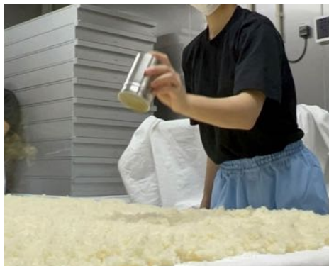
麴室の中の大きな作業台の上に蒸米を均一に広げていき（左）、その上に決められた量の種麴を均等に振りかけていく（右）。一発勝負だ。
