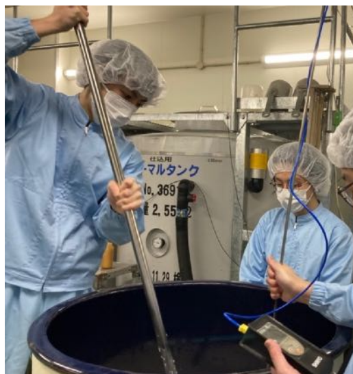
写真-2 酏立の様子。温度を測りながら攪入を行っている。
