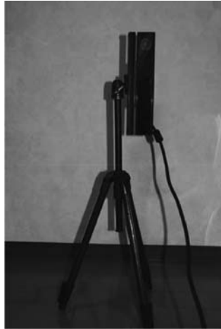
図 2.2 Kinect はこのように縦長に設置する。その際に、丸く見えている RGB カメラが上になるようにする
